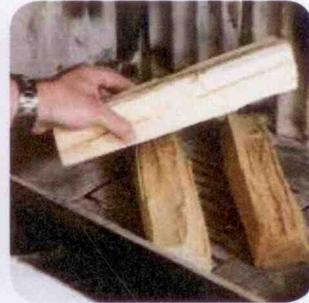
Das Holz locker in den Brennraum schichten.
